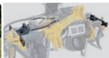
Inclinazione degli elementi di lavoro a regolazione idraulica indipendente
