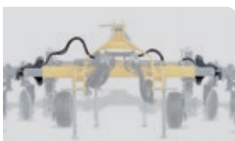
Inclinazione a regolazione idraulica indipendente
