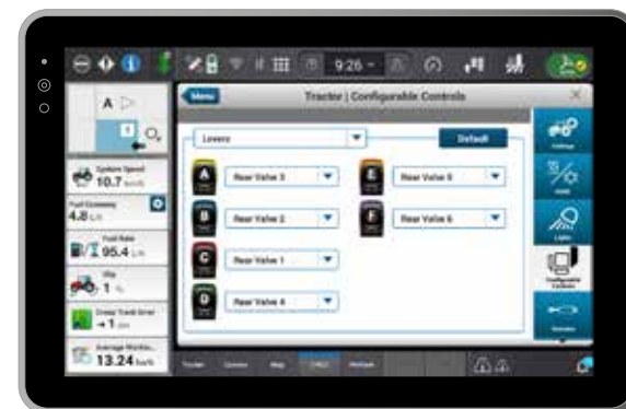
I tasti di scelta rapida vi portano direttamente ai menu delle impostazioni in cui potete configurare i vostri distributori ausiliari.
